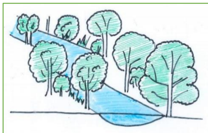
Milieu ouvert après entretien de la ripisylve
